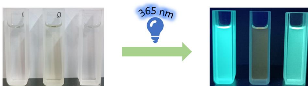
图1 溶液中先后加入酸碱荧光变化图（激发波长：365 nm 紫外灯）
