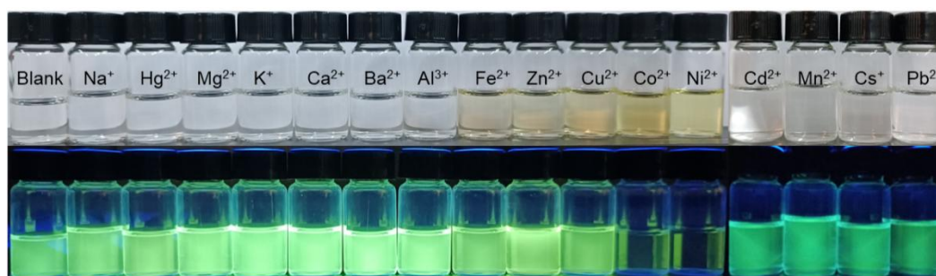
图 5 加入金属离子荧光变化图（激发波长：365nm 紫外灯）
